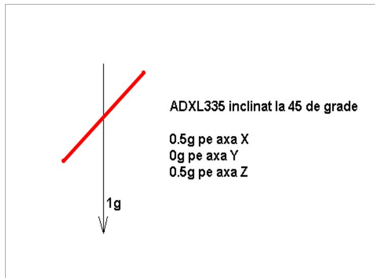
Acceleratiile citite de accelerometru sunt inmultite cu o valoare constanta (in cazul nostru cu 3, valoarea constantei SENSIBILITATE\_X) si mouse-ul este miscat pe ecran corespunzator valorii obtinute. Poate vei spune ca o deplasare de 3 pixeli atunci cand accelerometrul este inclinat maximum este putin, dar adu-ti aminte ca functia *loop* se executa non-stop, astfel incat mouse-ul este miscat cu 3 pixeli la fiecare 50 de milisecunde (pentru ca in *loop* exista o instructiune *delay(50)*).
